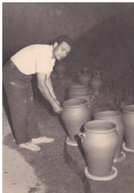
Fig. 3. Operación de enasado: Paco Arance en la década de los cincuenta colocando las asas de las orzas; se puede observar que las orzas están sobre olmas, y estas a su vez, sobre el barro almacenado en el obrador. Al fondo botijos a los que ya se les han colocado las asas, bocas y pitorros (Fuente: gentileza de hijos de Francisco Arance)
