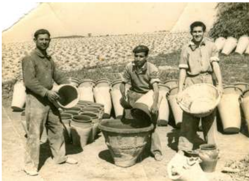
Fig. 4. Alfarería de Lombardo, 1950. En el centro, el maestro baña una orza de “a cuartillo” flanqueado por dos ayudantes; tras ellos, grandes orzas de tres cuartillos ya bañadas expuestas al sol. Es de destacar la antigua y hermosa almágina decorada con cordones digitados donde se realiza la operación (Fuente: Colección particular)
