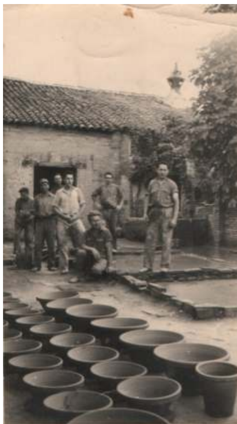
Fig. 1. Operarios en el patio de la alfarería de “Los Rosarios” en 1959. Al fondo a la derecha, el pilón de batido, y delante de este las pilas de decantación del barro. En primer plano lebrillos y maceta secándose al sol (Fuente: Colección particular)
