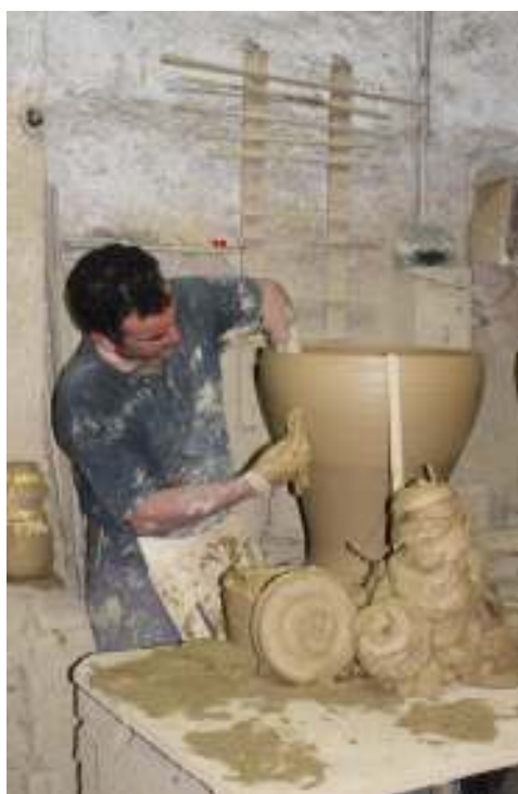
Fig. 2. Fotografía actual de la Alfarería de Los Magníficos, en la que vemos a Miguel Cózar alisando el tiesto o parte baja de las dos que compondrán una de sus grandes orzas. Para esta operación se ayuda de la caña que sostiene con su mano derecha mientras la izquierda presiona por el interior de la vasija. También puede verse el albañal donde el artesano moja sus manos para modelar y el escantillón clavado en el barro que permite medir la altura de la pieza. En la pared, detrás de él, se alinean ordenadas, las medidas que utiliza para calibrar las anchuras de sus cacharros (Foto del autor)
